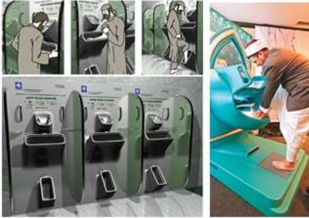
شكل " 29 " اجهزة وضوء اتوماتيكية تعمل بالاستشعار بالأشعة تحت حمراء لتوفير أكبر قدر ممكن من مياه الوضوء
